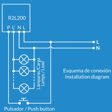
Esquema de conexión
