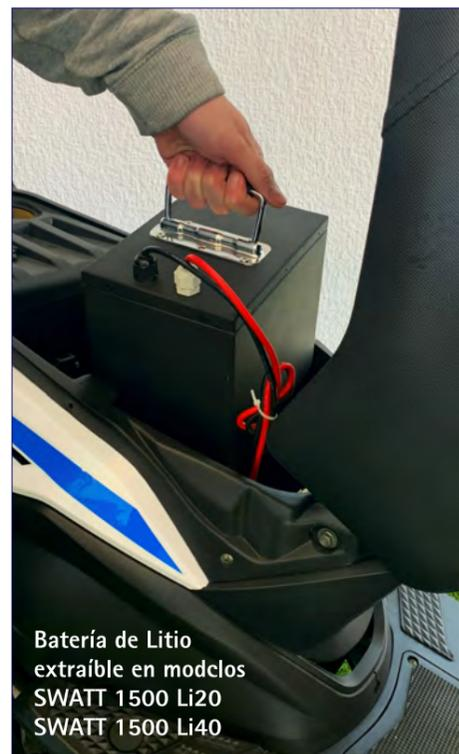
Batería de Litio extraíble en modelos SWATT 1500 Li20 SWATT 1500 Li40
